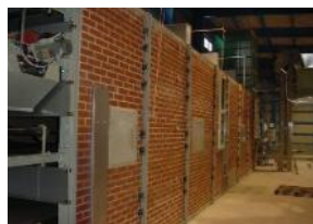
〈輻射熱を利用した乾燥工程〉
